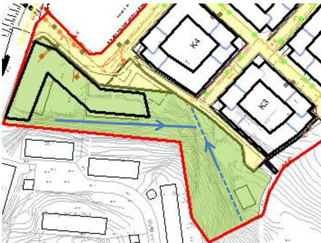
Figur 11. Illustration över makadamdikens placering för fördröjning, rening och avskärande funktion (heldragen linje), avskärande funktion (streckad linje).
