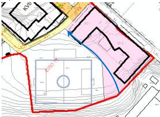
Figur 14. Illustration över makadamdikens placering för fördröjning, rening och avskärande funktion (heldragen linje).
